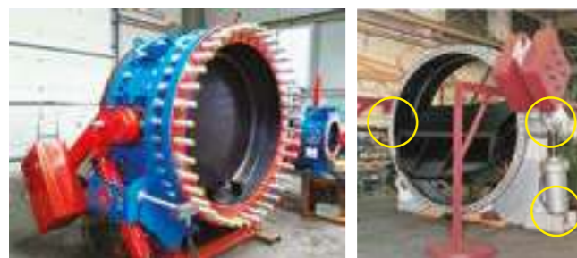
Рис. 6. Еще примеры не самых удачных конструкций комбинированных затворов
