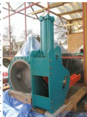
Фото 1 — Обратные клапаны MIV V2-09V/A с одним демпфером
