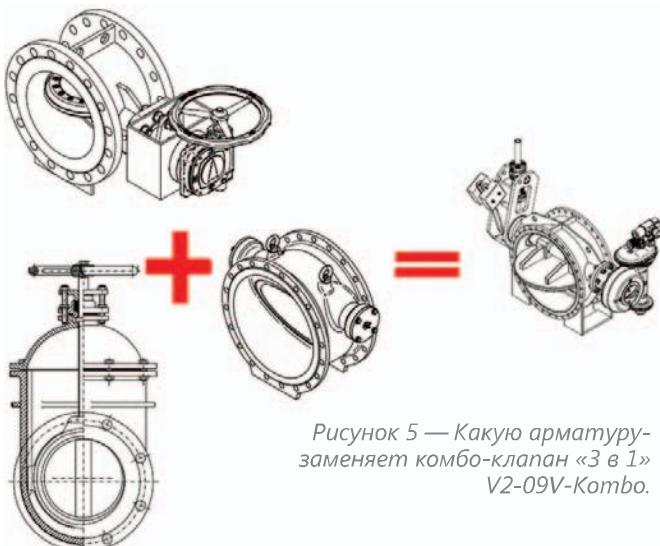
Рисунок 5 — Какую арматуру заменяет комбо-клапан «3 в 1» V2-09V-Kombo.
