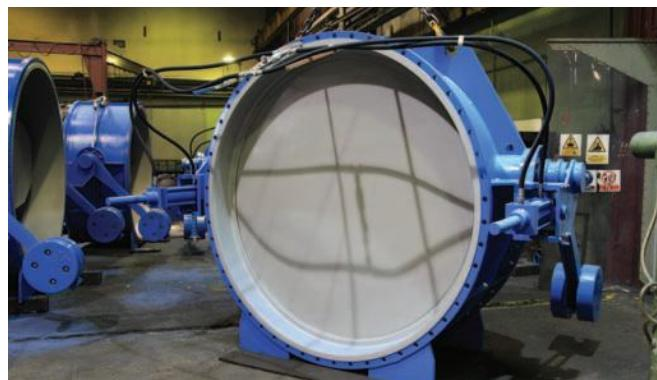
Фото 2 — Обратный клапан MIV V2-09V/2A с двумя синхронизированными демпферами Ду 2200 для Ростовской АЭС.
