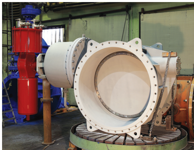
Фото 2 — Клапан Ду1400 с пневмоприводом ROTORK на заводе, после испытаний
