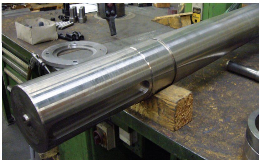
Рисунок 13 — Все варианты приемлемы. Качественная и точная обработка валов арматуры присутствует
