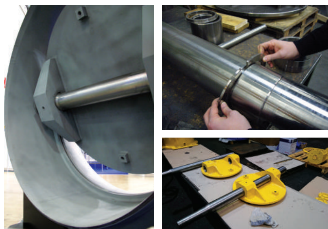
Рисунок 11 — Массивный вал (под призматическую шпонку) из качественной н/ж стали 1.4021. На фото затвор Ду 1400
