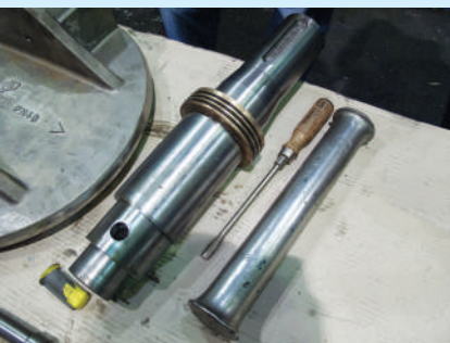
Рисунок 18 — Уплотнение вала дискового затвора на холодную воду. Один из вариантов
