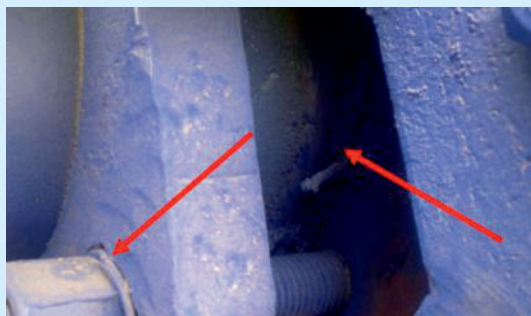
Рисунок 11 — Массивный вал (под призматическую шпонку) из качественной н/ж стали 1.4021. На фото затвор Ду 1400
