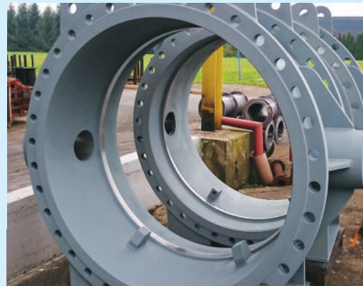
Рисунок 15 — На крайнем слева фото — ограничитель «каким он не должен быть». На двух других фото — солидный дизайн ограничителей, один из признаков надежной арматуры
